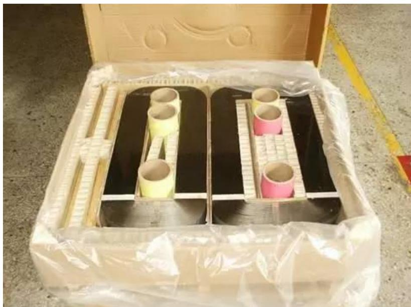
图 2 采购的非晶合金带材单框原材料
